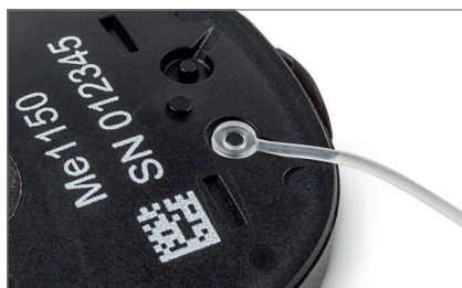
Fig. 13 Fissaggio della clip all'involucro del RONDO 2
